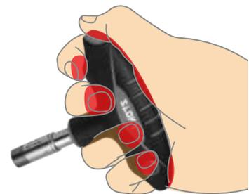
La poignée en T est particulièrement adaptée pour serrer ou desserrer des couples élevés. La force est transmise de manière positive, sans perte de friction entre la main et la poignée.
