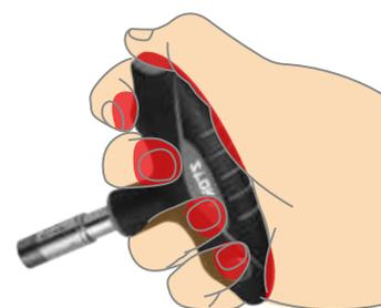
T型ハンドルは、特に高いトルクで緩める・締める作業が必要なときに必要とされるものです。手とハンドルの間に摩擦損失がないため、力が必ず伝達されます。
