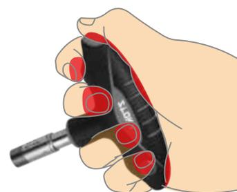
El mango en "T" es el más adecuado en los casos en que se necesite aplicar un par de torsión especialmente alto para apretar o aflojar tornillos.
