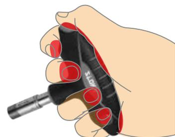
Der T - Handgriff wird benötigt, wenn besonders hohe Drehmomente zu lösen oder festzuziehen sind. Die Kraft wird positiv übertragen, es gibt keine Reibungsverluste zwischen der Hand und dem Griff.
